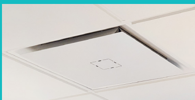
Det reaktiva tilluftsdonet ISQM-200. Donet saknar egen aktiv styrning. Donet är liksom ISQ utrustat med mekanik för en spaltöppning som ökar och minskar med luftflödet. Ställbar spridningsbild.
