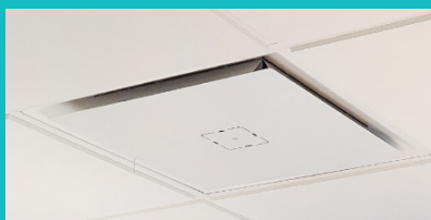
Det aktiva taktilluftsdonet ISQ-200 med integrerad spjällmotor, rumsklimatsregulator och givare. Systemet medger variabelt luftflöde från enskilda don. Donet är utrustat med mekanik för en spaltöppning som ökar och minskar med luftflödet. Ställbar spridningsbild.
