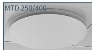
Reaktivt tilluftsdon med fast underplåt. Utan egen styrning men med spaltöppning som följer luftflödet. Alt: MTN-400 med rörlig underplåt.
