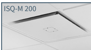
Reaktivt tilluftsdon utan egen styrning. Spaltöppningsmekanik som följer luftflödet. Ställbar spridningsbild.
