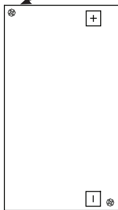
Illustration M4. Lock orienterat för att korrekt markera + och -.
